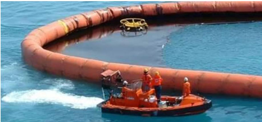
Для локализации разлива используются боновые заграждения. Боны размещаются по периметру нефтяного пятна на поверхности воды и удерживаются на плаву при помощи якорей.
